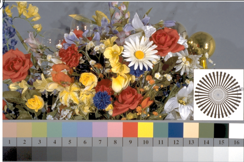
TF990-3, Fig. D1W--: motif fleuri, 14 CIE test couleurs et 2 + 16 paliers de gris (sf); PS opérateur: 4 colorimage
