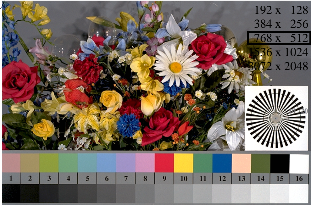
TS900-3, Fig. B1We: motivos florales, CIE 14 colores del test y 2 + 16 pasos de gris (nf); : PS 3 colorimage
